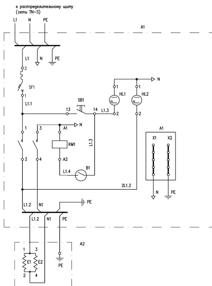
Рисунок 2.3. Схема электрическая принципиальная, аквадистиллятор ДЭ–4М.
