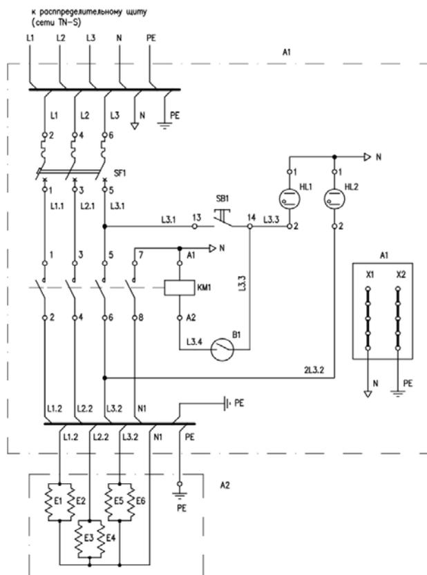
Рисунок 2.1. Схема электрическая принципиальная, аквадистиллятор ДЭ–25М
